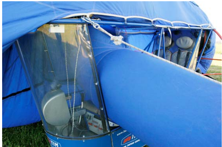
Figure 19 : gonflement du GEFA avec manche de gonflement raccordée à la nacelle et au ventilateur
