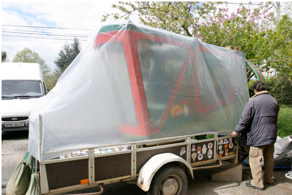
Figure 11 : vérification des dimensions de la bâche avec un modèle transparent
