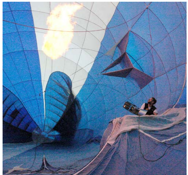
Figure 8 : brûleur en position, le pilote est obligé de l'incliner pour chauffer l'enveloppe
