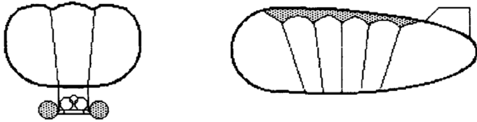
Figure 15 : exemple de caténares internes, vue de devant, vue de profil (coupes)
