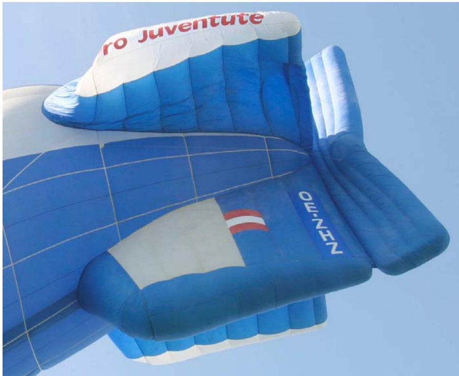
Figure 6 : l'unique point d'accroche sur la gouverne est insuffisant
