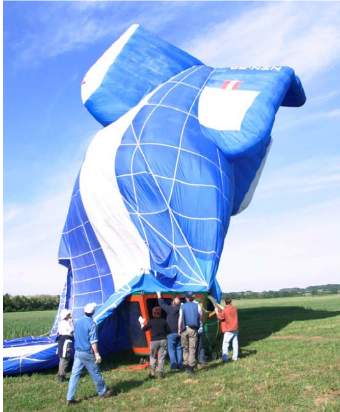
Figure 24 : état du dirigeable après ouverture du panneau de déchirure en position centrale
