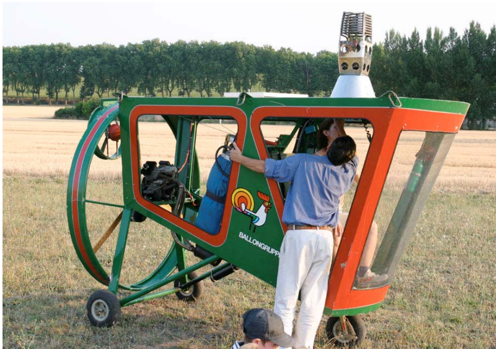
Figure 7 : brûleur en position
