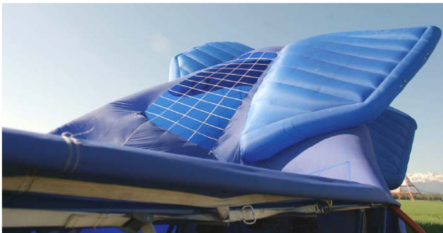
Figure 25 : état du dirigeable après ouverture du panneau de déchirure en position arrière (machine Gefa Flug)
