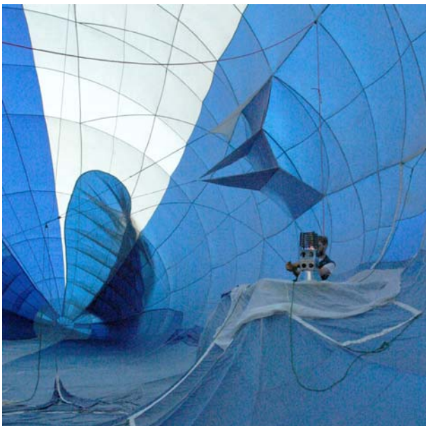
Figure 8 : brûleur en position, le pilote est obligé de l'incliner pour chauffer l'enveloppe
