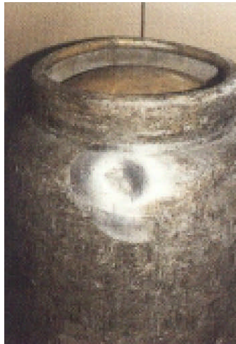
fig. 3 : cylindre avec un creux dans touchant l'arrondi inférieur
