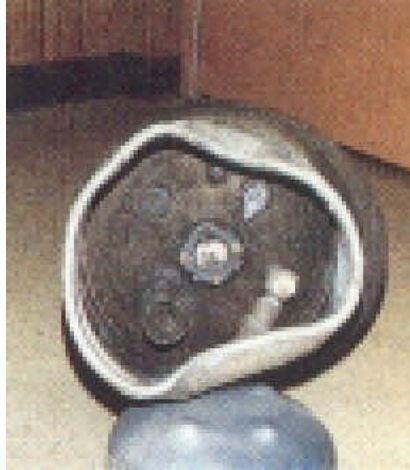
fig. 6 : cylindre endommagé par le feu montrant des protubérance et marque de fonte
